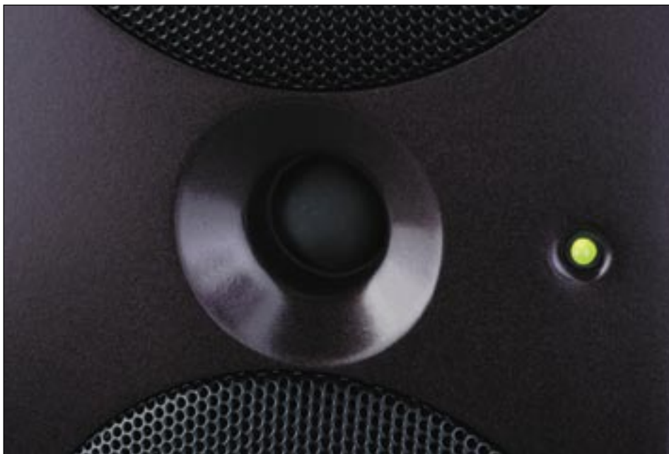
Schallführungselement für den Hochtöner aus Seidengewebe
