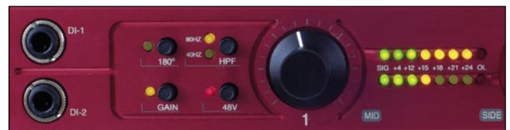
Eingangsbereich mit DI-1 und DI-2 sowie Pegelanzeige
